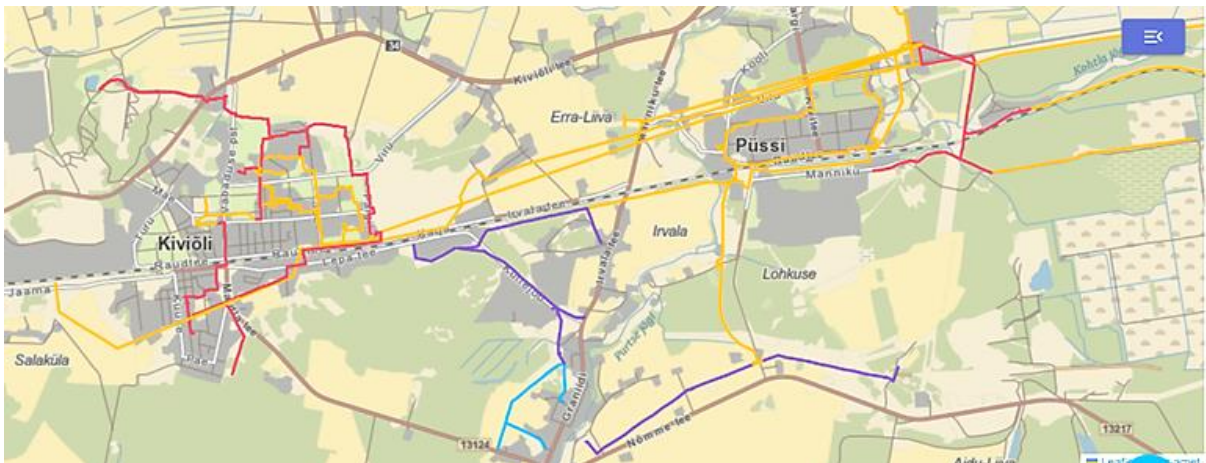
Joonis 16 – Vabad võimsused Kiviõli ja Püssi linnas, punasega 5000 kW, kollasega 1000 kW, lillaga 500 kW, sinisega 200 kW
